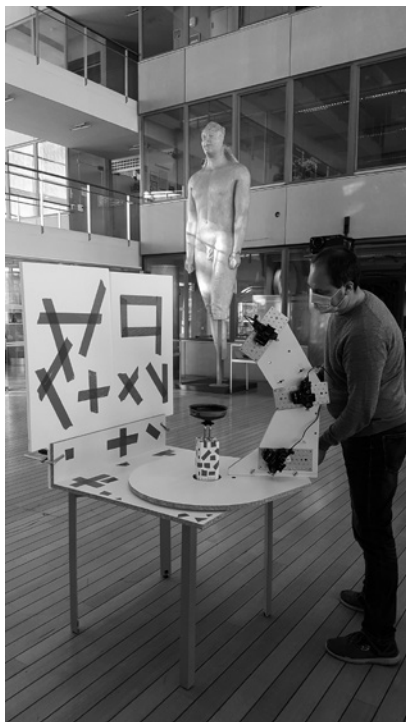
Abb. 2: Aufnahme einer griechischen Schale mit dem mobilen Setup mit Drehstativ, Foto: Kathrin Schuchter.
